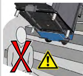
Fig. 19: Transport sécurisé d'un four avec un monte-escalier (figure analogue)
