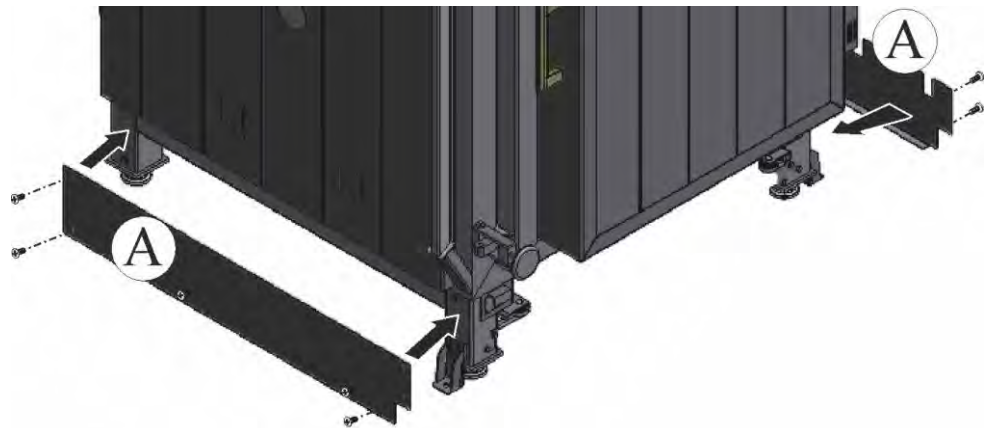
Fig. 37: Montage des tôles latérales (figure analogue)
